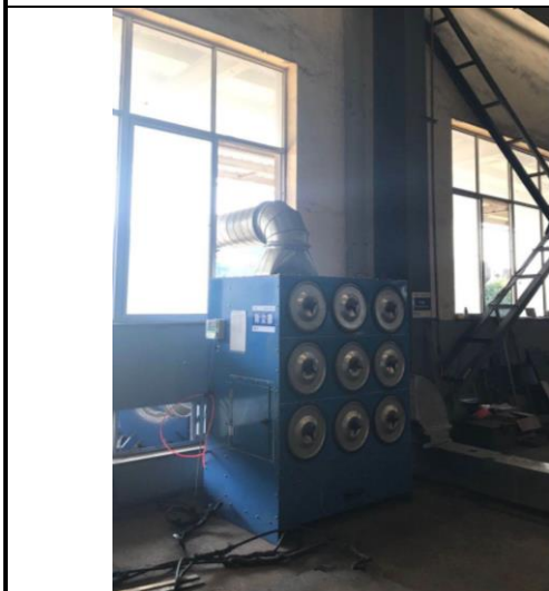
等离子切割机配套滤筒除尘器及排气筒
